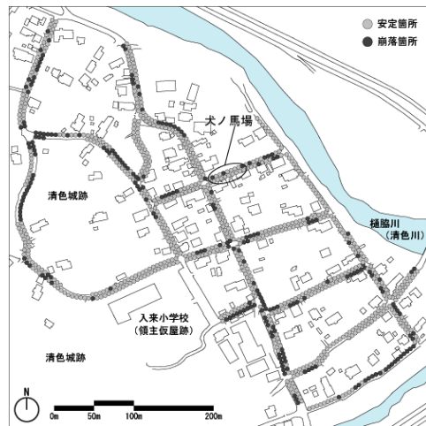
沿道要素における安定・崩落の分布状況
